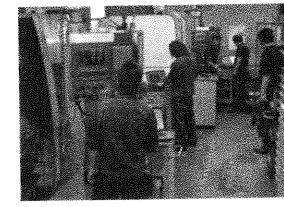
図2 工場内無線LANの設定作業 ネットワークライセンス契約のOneCNCを各マシニングセンタごとに使えるように無線LANの設定作業。外部に依頼せず自前で実施した。同社では、「VARIAXIS-500-5X」(ヤマザキマザック製、2パレットチェンジャ仕様)と「VARIAXIS-630-5XII」(同・超高精度仕様)の2台の5軸機と、5台の3軸MCが稼働。
